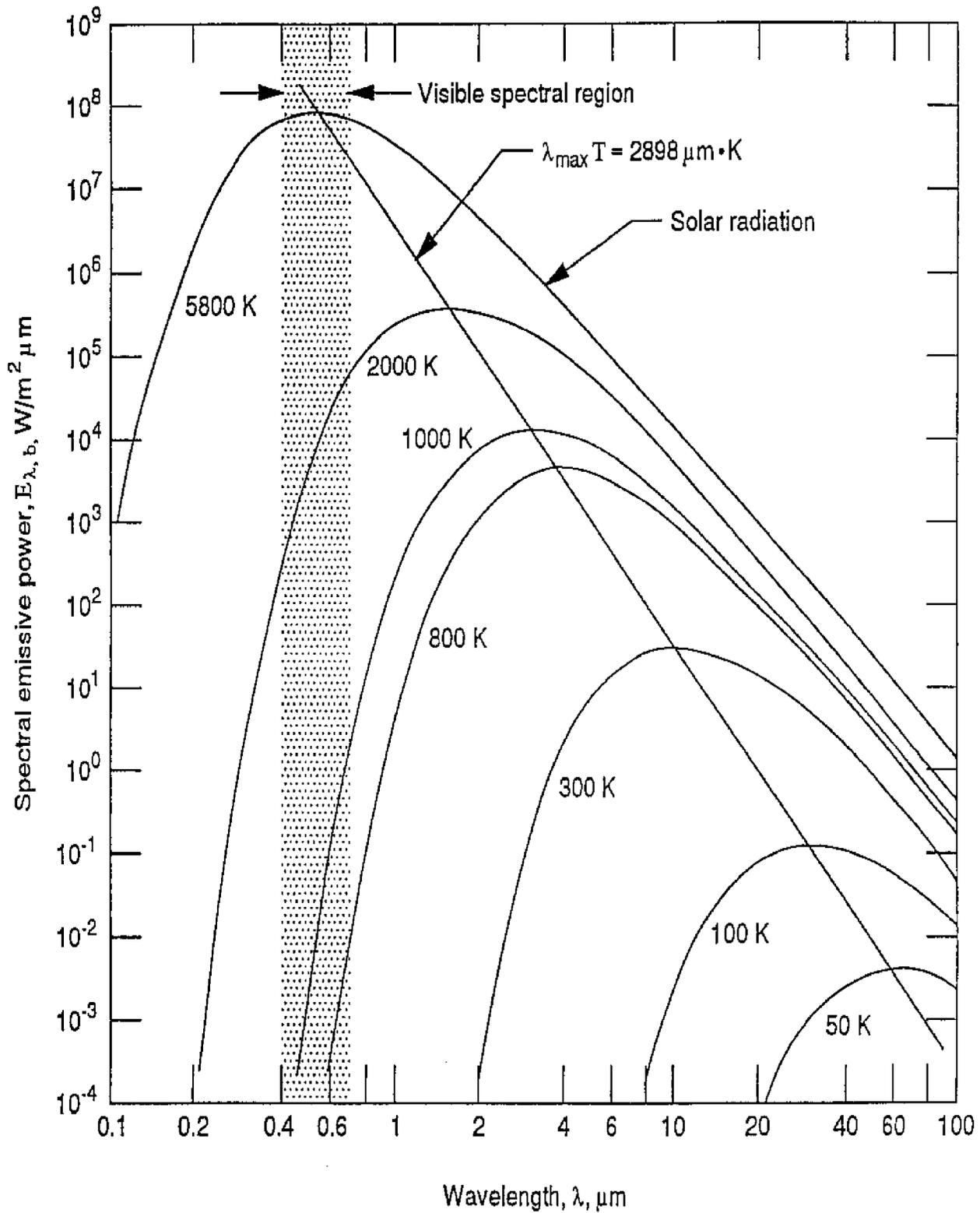
FIGURE 2. SPECTRAL BLACKBODY CURVES AT VARIOUS TEMPERATURES
